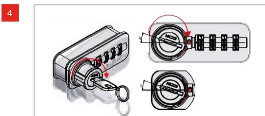
Codierpin im Drehknopf herunterdrücken (z.B. mit einer Codierhilfe oder einem Kugelschreiber) und mit heruntergedrücktem Codierpin den Knopf auf ca. 20° verdrehen bis der Pfeil am Drehknopf mittig auf das rote Dreieck am Schlossgehäuse ausgerichtet ist.
