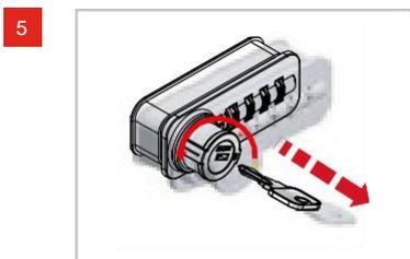
Drehknopf auf bestehender 20° Position (der Pfeil am Drehknopf steht mittig auf dem roten Dreieck am Schlossgehäuse) festhalten und NUR den Schlüssel gegen den Uhrzeigersinn 180° zurückdrehen und entnehmen.
