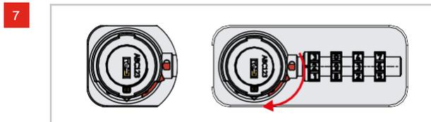
Drehknopf im Uhrzeigersinn bis zum Anschlag weiterdrehen. Code springt auf „0000“.
