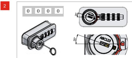
Codierpin im Drehknopf herunterdrücken (z.B. mit einer Codierhilfe oder einem Kugelschreiber) und mit heruntergedrücktem Codierpin den Knopf auf ca. 20° verdrehen bis der Pfeil am Drehknopf mittig auf das rote Dreieck am Schlossgehäuse ausgerichtet ist. Es ist ein kleiner Widerstand zu spüren. Die Codierhilfe wird nicht mehr benötigt.
