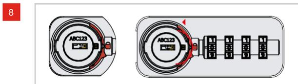
Drehknopf gegen den Uhrzeigersinn zurückdrehen bis zum Anschlag. Codierpin springt in Ausgangsstellung zurück.
