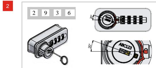
Gültigen Benutzer Code einstellen. Codierpin im Drehknopf herunterdrücken (z.B. mit einer Codierhilfe oder einem Kugelschreiber) und mit heruntergedrücktem Codierpin den Knopf auf ca. 20° verdrehen bis der Pfeil am Drehknopf mittig auf das rote Dreieck am Schlossgehäuse ausgerichtet ist. Es ist ein kleiner Widerstand zu spüren. Die Codierhilfe wird nicht mehr benötigt.
