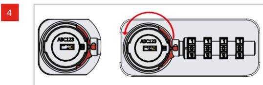
Knopf zurückdrehen auf geschlossen Position. Codierpin springt in Ausgangsstellung zurück. Schloss öffnen und schließen. Code ist verwischt.
