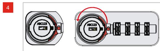
Knopf zurückdrehen auf geschlossen Position. Codierpin springt in Ausgangsstellung zurück. Schloss öffnen und schließen. Code ist verwischt.
